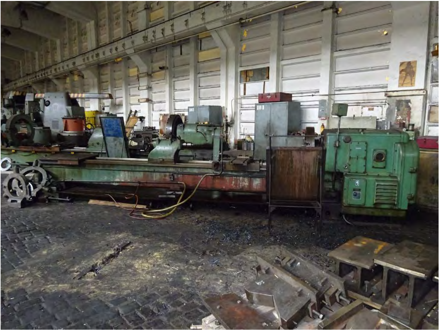
Rb.1781. (Ib.0002899) • UNIVERZALNA TOKARILICA , mod. TES 4-4500, pr. Prvomajska
