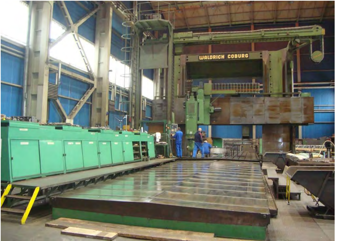
Rb.1810. (Ib.0004619) • PORTALNA GLODALICA , tip. 24-10 FP 450, pr. Waldrich Coburg
