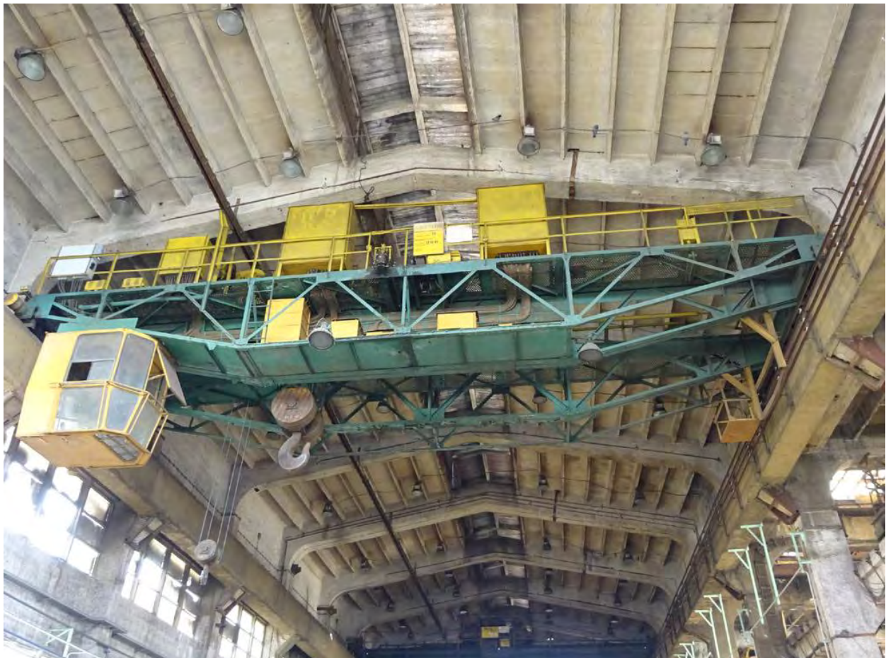
Rb.1663. (lb.0001176) • DVOGREDNA MOSNA DIZALICA , tip. DMD 22/5T / 15m, pr. Uljanik
