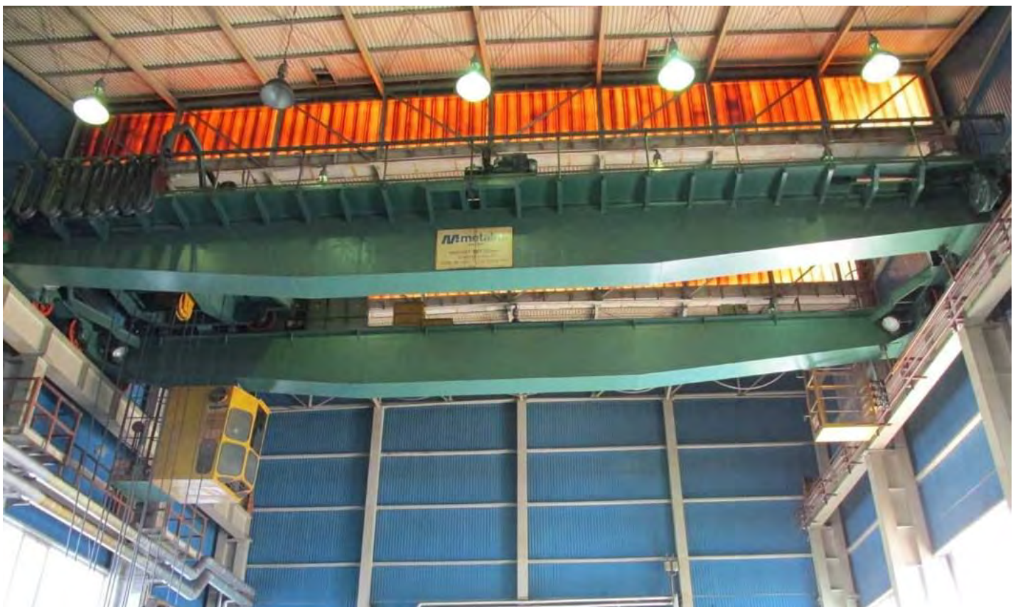
Rb.1809. bIb0004617 • DVOGREDNA MOSNA DIZALICA , tip. DMD 80/20T / 19m, pr. Metalna
